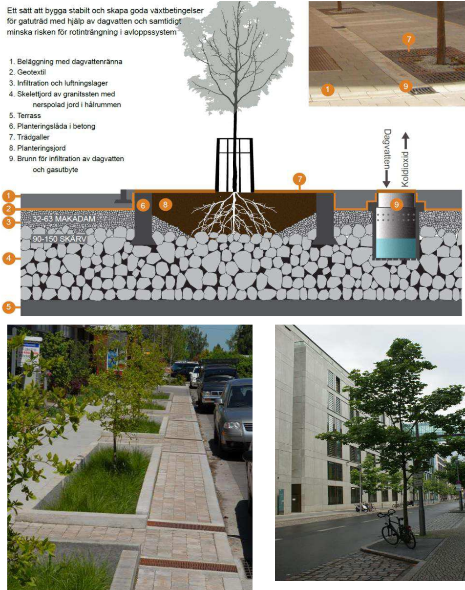
Figur 5. Principskiss på täckta träd i skelettjord (övre bild) och bildexempel på nedsänkta öppna växtbäddar (t.v.) och på träd i skelettjord (t.h.).
